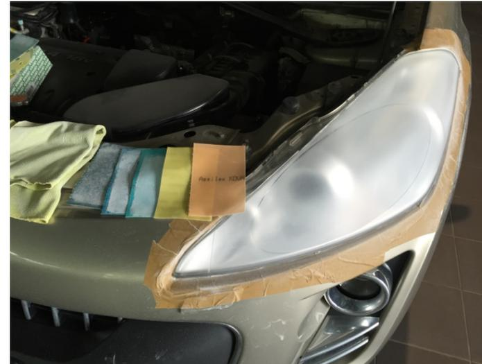
В зависимости от выбранной схемы ремонта последовательно использовать абразив, начиная с градации P180.
