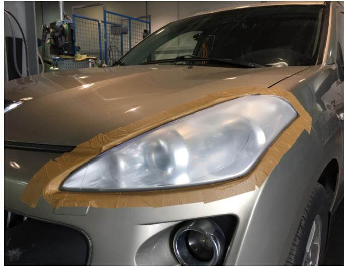
Очистить фару с помощью водно-спиртового обезжиривателя.
