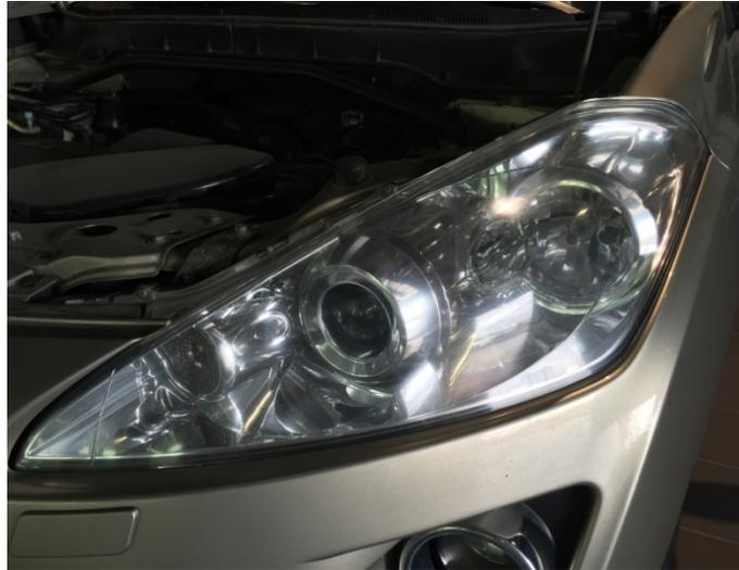
Очистить фару с помощью водно-спиртового обезжиривателя.
